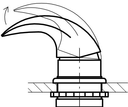
Páčka v poloze NULA uzavírá vodu. Při otáčení páčky VE SMĚRU hodinových ručiček nám začne téct voda přes výtok (chrlič) do vany. Čím více se budeme oddalovat od nulového bodu, tím teplejší voda se nám bude mixovat (viz obrázek). Na této straně pootočení ještě můžeme regulovat i průtok vody nakloněním páčky nahoru od 0–24l/min při tlaku 3barů.
